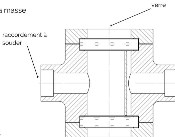
fig 3 : indicateur de débit, version monobloc, montage à souder SW
