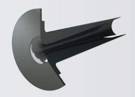
L'état sonique de la tuyère signifie que l'écoulement atteint la vitesse du son au passage du col. Dans ces conditions, le débit dépend principalement de la pression amont et de la température du fluide. Cela permet de délivrer un débit stable et parfaitement connu, indépendant des conditions de pression aval de la tuyère.
