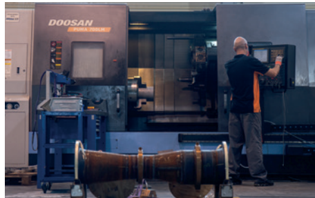
Tour CN horizontal 3 axes + axe C, grande capacité
