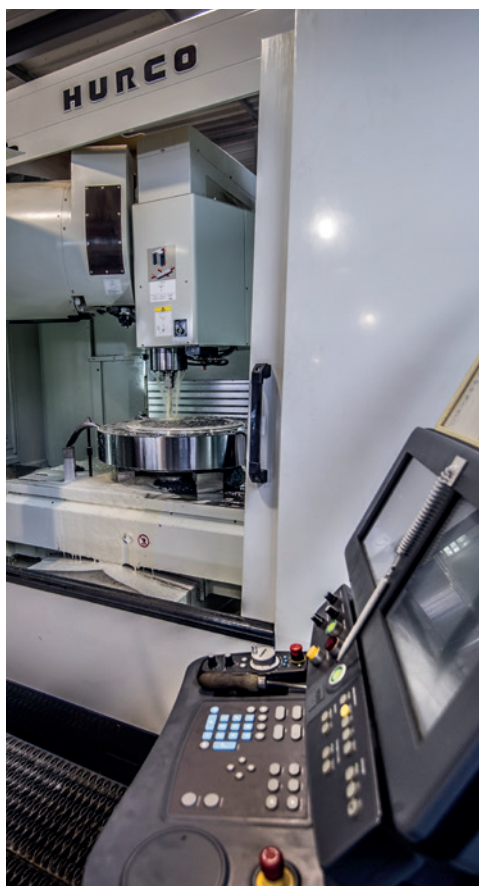
Centre d'usinage 4 axes
