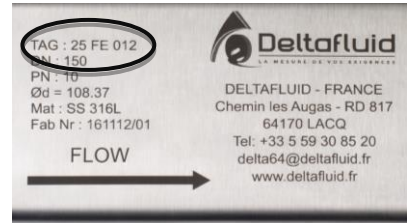
Fig 2 : data plate for venturi tube Fig 2 : Plaque de marquage sur venturi
