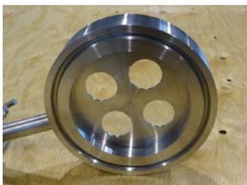
Photo 5 : Débitmètre compact (2 prises de pression intégrées) 4 trous RTJ
