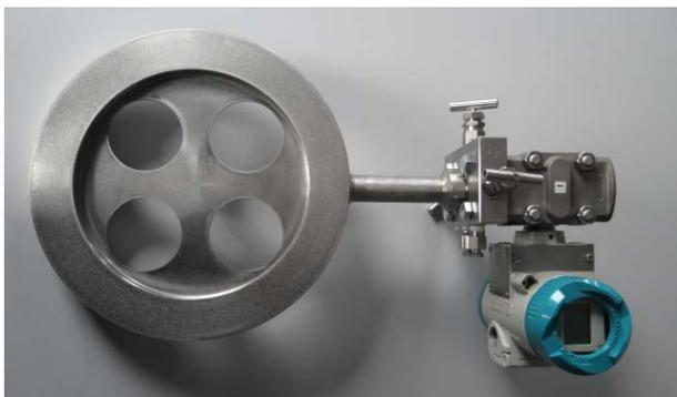
Photo 4 : Débitmètre compact (2 prises de pression intégrées) 4 trous RF avec manifold et transmetteur de pression différentielle
