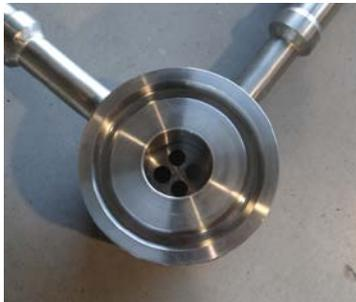
Photo 2 : Monobloc RTJ avec plaque 4 trous et 2 nipples prises de pression centrées
